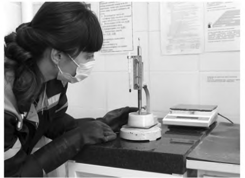
Для определения нормальной густоты цементного теста используется прибор «Вика» фирмы TESTING (Германия)
