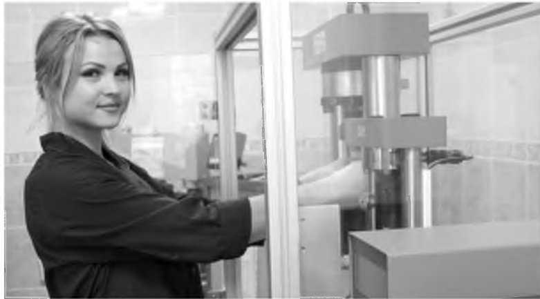
Лаборант Ирина Рожкова проводит испытание цемента на сжатие
