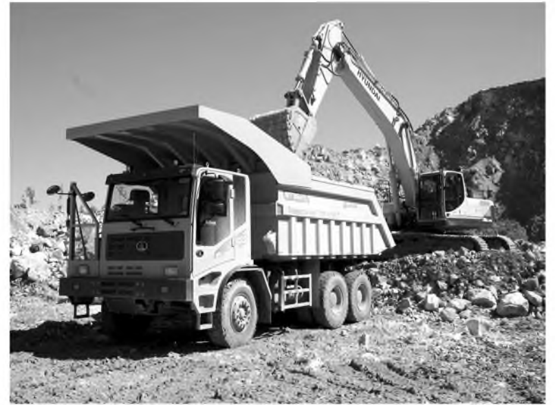
Грузоподъемность китайского самосвала составляет 60 тонн
