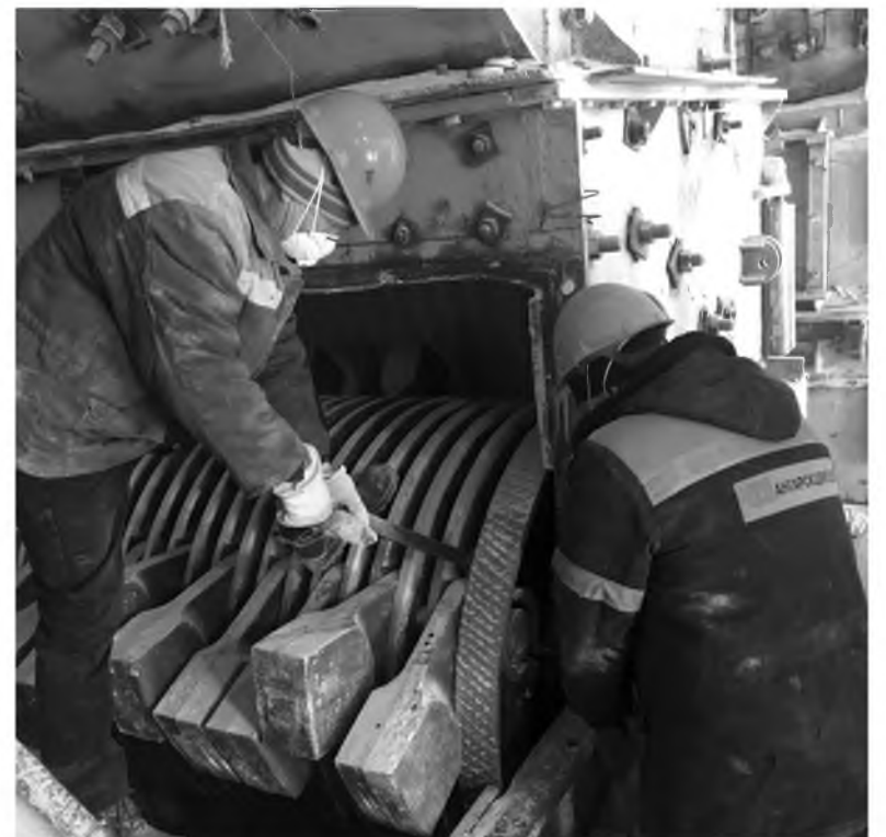
Экспериментальные молотки дробят почти в 2 раза больше горной массы по сравнению с традиционными
