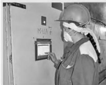
Настройку дозаторов производит машинист мельницы с местного поста управления либо с операторской панели в шкафу
