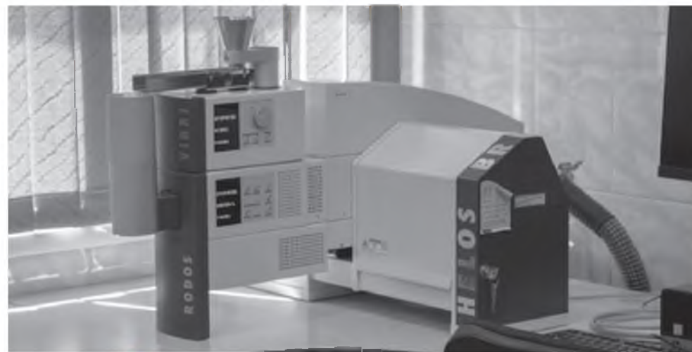
В лаборатории потребителям продукции продемонстрировали пневмоклассификатор для определения тонкости помола цемента
